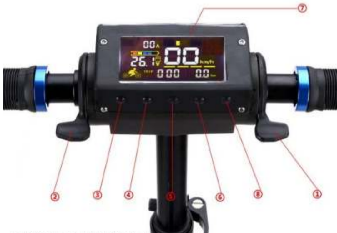
1. Páčkový akcelerátor | 2. Palcová elektronická magnetická brzda | 3. Tlačítko houkačky | 4. Tlačítko nastavení | 5. Spínač | 6. Tlačítko světla | 7. LCD displej | 8. Úroveň rychlosti
