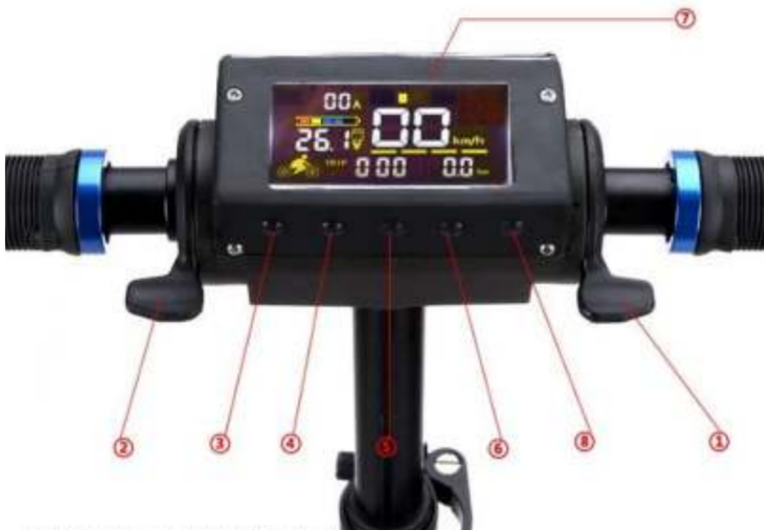
1. Hüvelykujjas gyorsító | 2. Hüvelykujjas elektronikus mágnesfék | 3. Kürt gombja | 4. Beállítás gomb | 5. Kapcsológomb | 6. Világítás gomb | 7. LCD-kijelző | 8. Sebességfokozat
