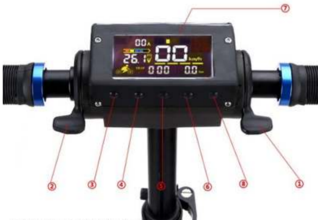
1. Páčkový akcelerátor | 2. Palcová elektronická magnetická brzda | 3. Tlačidlo klaksónu | 4. Tlačidlo nastavení | 5. Vypínač | 6. Tlačidlo svetla | 7. LCD displej | 8. Úroveň rýchlosti
