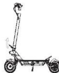
1. Scoateți suportul și fixați mecanismul de pliere.
