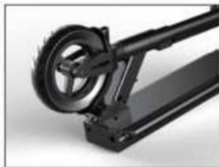
Krok 6: při skládání přední části zatlačte dopředu a současně držte páčku stisknutou.
