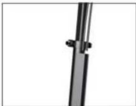
Step 4: unscrew the nut. Krok 4: odšroubujte matici.
