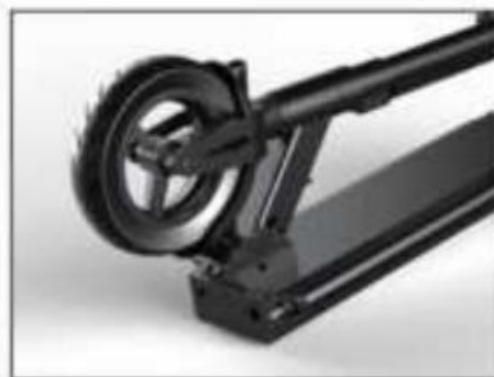
Pasul 6: împingeți înainte și țineți simultan maneta apăsată când pliați partea din față.
