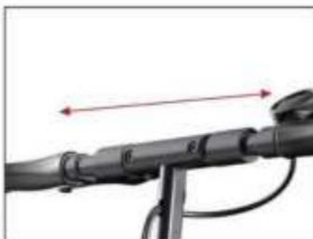
Pasul 2: extindeți spre exterior manșonul în formă de T
