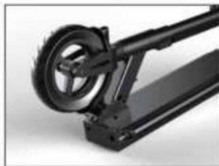
6. lépés: a fej összecsukásakor tolja előre, és közben tartsa lenyomva a kart.
