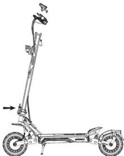
3. Zajistěte skládací mechanismus. (Viz postup rozkládání.)
