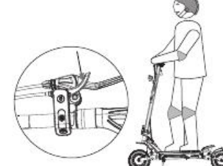
4. Po plynulém rozjezdu dejte obě nohy na plošinu a mírně přidejte plyn.
