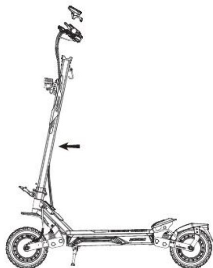
2. Împingeți tija înainte până devine dreaptă.
