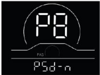
Obr. 4-8 Nastavení hesla při zapnutí
